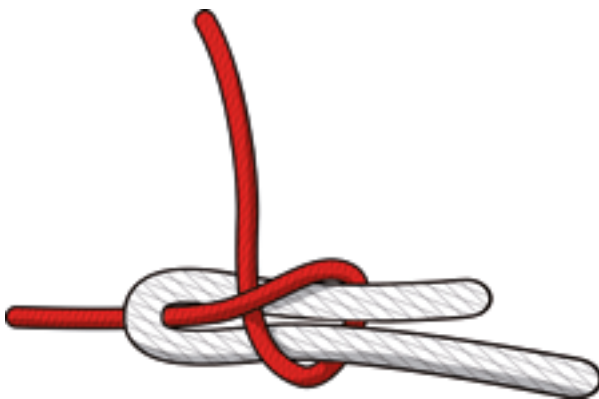
Abbildung: Einfacher Schotstek
