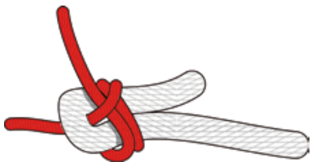
Abbildung: Doppelter Schotstek
