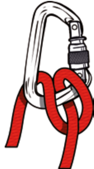
Abbildung: Karabiner mit HMS-Knoten
